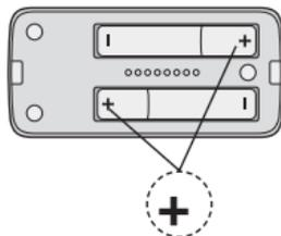
Setzen Sie die neuen Batterien in das Batteriefach ein.
