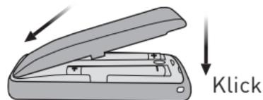
Setzen Sie die Batterieabdeckung an der Spitze ein.
