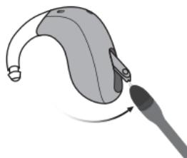
Drücken Sie das Werkzeug in die Öffnung, und ziehen Sie es wieder heraus, um die Tasterabdeckung zu öffnen. Halten Sie dabei das Multifunktionswerkzeug wie dargestellt, um Schäden zu vermeiden.
