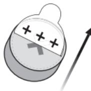
Ziehen Sie die Schutzfolie von der + -Seite der neuen Batterie ab.
