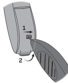
**i** **Wichtig: Öffnen Sie das Batteriefach nicht weiter als nötig. Legen Sie die Batterie richtig ein. Starker Druck kann das Batteriefach deformieren.**
