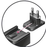
3. Drücken Sie zum Entfernen des Steckers auf die Klinke und schieben Sie den Stecker weg vom Kabel.
