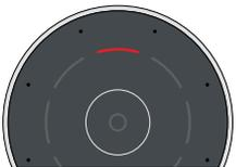
Eine rote LED weist auf eine Akkulaufzeit von weniger als 1 Stunde hin. Ein blinkendes rote Licht weist auf eine leere Batterie an.
