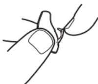
3. Entfernen Sie den farbigen Schutzstreifen von der neuen Batterie. Die besten Ergebnisse erzielen Sie, wenn Sie nach dem Entfernen des Schutzstreifens 3–5 Minuten warten, bevor Sie die Batterie einsetzen.
