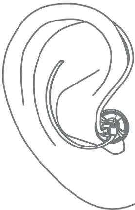
Der optionale Conchaclip hilft, den Sitz der Hörereinheit im Ohr zu verbessern. Um den Conchaclip zu positionieren, biegen Sie diesen leicht und legen Sie den Conchaclip vorsichtig in die Ohrmuschel.
