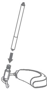
Ziehen Sie zunächst den Dome von dem Hörermodul und reinigen Sie diesen.
