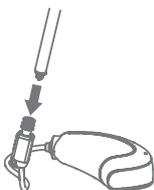
Drücken Sie den neuen Filter mit dem Wechselwerkzeug bis zum Einrasten in die Filteröffnung des Hörgerätes. Danach ziehen Sie das Wechselwerkzeug einfach ab und entsorgen dieses.
